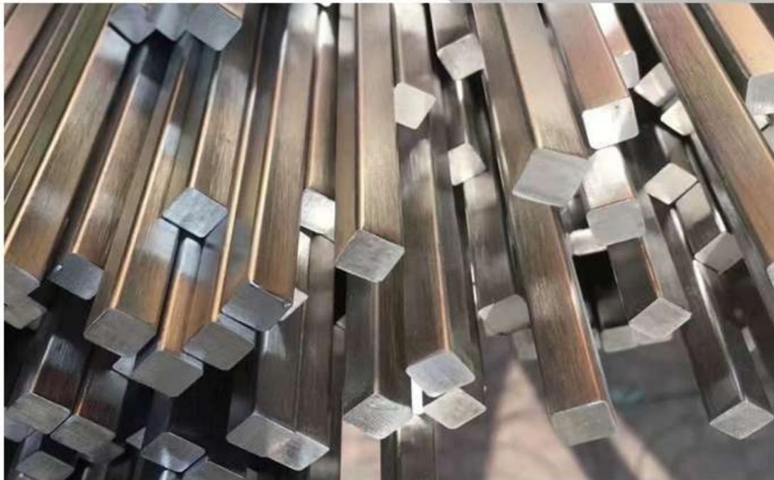
La forma cuadrada puede ofrecer mayor estabilidad y resistencia en orientaciones específicas en comparación con las barras redondas. Esto puede hacerlos preferibles para aplicaciones de carga.
